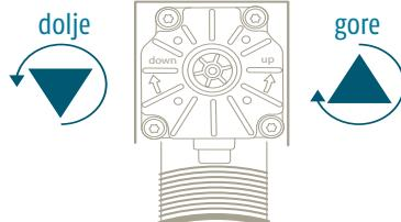
Sigurnosni prekidač može biti priključen sa obadvije strane motora, ovisno o načinu na koji motor je ugrađen u glavni profil.
